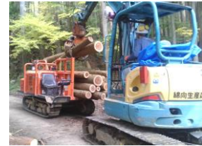
山土場荷下ろし
